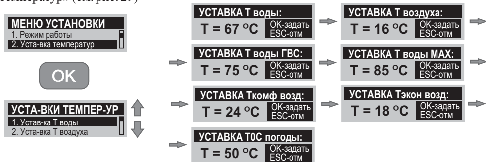
Рисунок 29. Установка температурных параметров.
